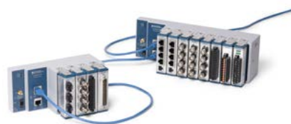
图 7 | 以太网支持100米范围的数据采集，并且能够利用现有的网络基础设施，因而大幅扩展了测量系统的覆盖范围。
